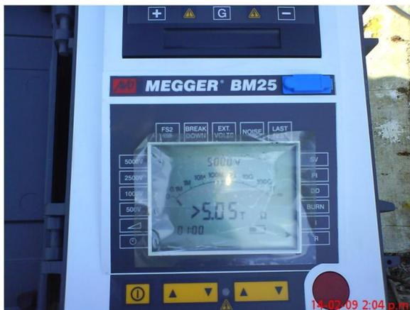
**Fig. 3. Medición de resistencia de la pértiga y la manguera.**
