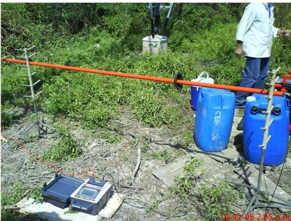
**Fig. 2. Medición de resistencia de la pértiga y la manguera.**
